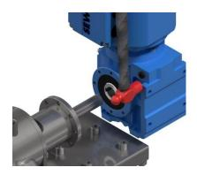
Con un alicate de pinzas retirar el seguro tipo seeger del eje del impulsor (el resaltado de color rojo).
