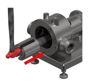
Con un alicate de pinzas colocar el seguro tipo seeger del rodamiento (el resaltado de color rojo).
