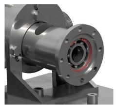
Utilizando un extractor interno retirar los 02 rodamientos de bolas, entre ambos rodamientos hay un distanciador de polietileno.
