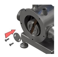
Girar manualmente el eje para verificar el libre movimiento. El ajuste de los rodamientos y la fricción de los sellos y de las paletas ocasiona resistencia al giro.
